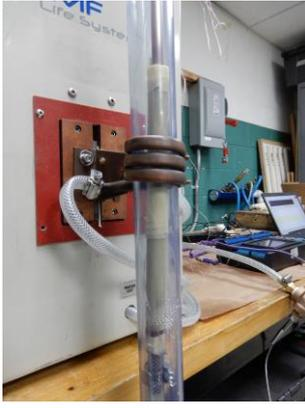
Fig. 2. Impeder test stand
